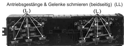
Das Getriebe der Lokomotive wurde bereits beim Hersteller geschmiert und benötigt kaum Wartung. Leistet die Lokomotive jedoch übermäßig viele Betriebsstunden mit hoher Zuglast, empfiehlt es sich, die 2 Schrauben des Getriebedeckels zu entfernen und das Getriebe mit M.T.H. Getriebefett oder einem gleichwertigen Produkt zu schmieren.
